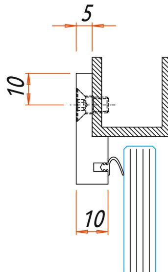
Ausführung Standard: Aluminium geschliffen, gebürstet
