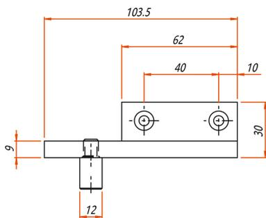
Ausführung Standard: Aluminium geschliffen, gebürstet
