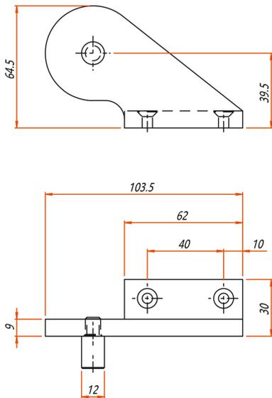
Exécution standard: aluminium oxydé pour épaisseur de verre 10 mm.
