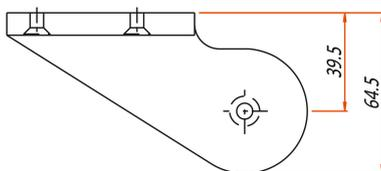
Exécution standard: aluminium oxidé pour épaisseur de verre 10 mm.
