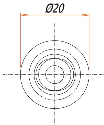
Exécution standard: aluminium oxidé pour épaisseur de verre 10 mm.
